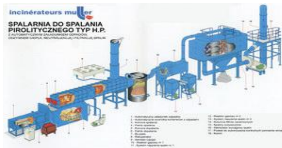
Ryc. 1 Instalacja pirolitycznej spalarni odpadów typu H.P. – polterm [1]
