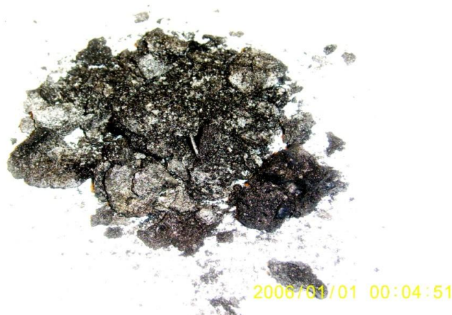
Ryc. 16 Karbonizat odpadów organicznych produkowanych przez ubojnię drobiu z widocznymi składnikami mineralno – organicznymi ( tlenkami)
